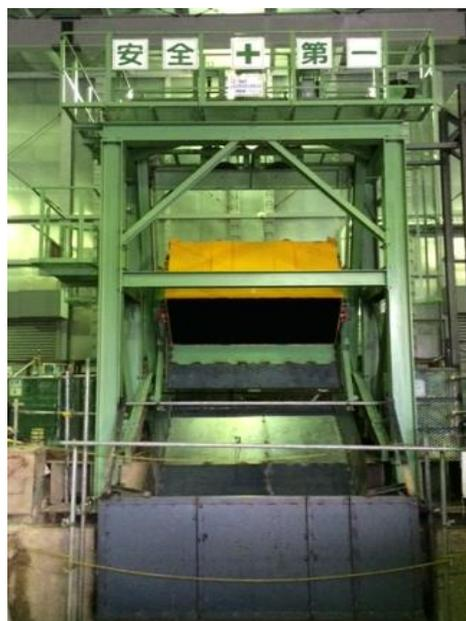
地下掘削ポイントから搬送されたずり鋼車を、そのまま垂直搬送する土砂搬送システムです。
